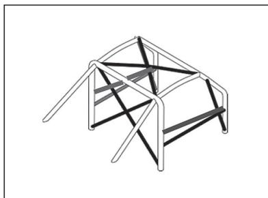
12.1.4) ロールバーの車体への取付け方法はFIA-J項253-8)規定に従った構造であり、ベース車の公認時期に関わらず2007年以降公認の方法に従うか、D1が本規定条文で指定する方法でなければならない。
